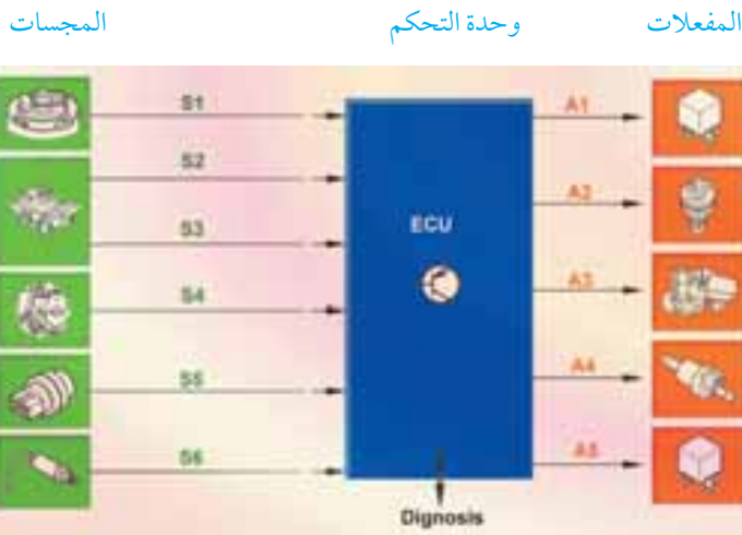
شكل (١٠) التحكم الالكتروني بنظام حقن البنزين المركزي
